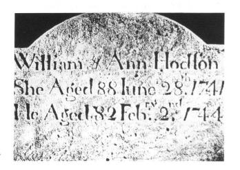
(b)Immagine ottenuta con l'impiego della Profilatura al Laser della Superficie (LASP) che permette la completa decifrazione della scritta.
