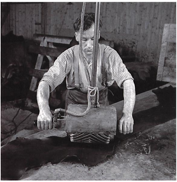
Ausrecken mit Maschine
