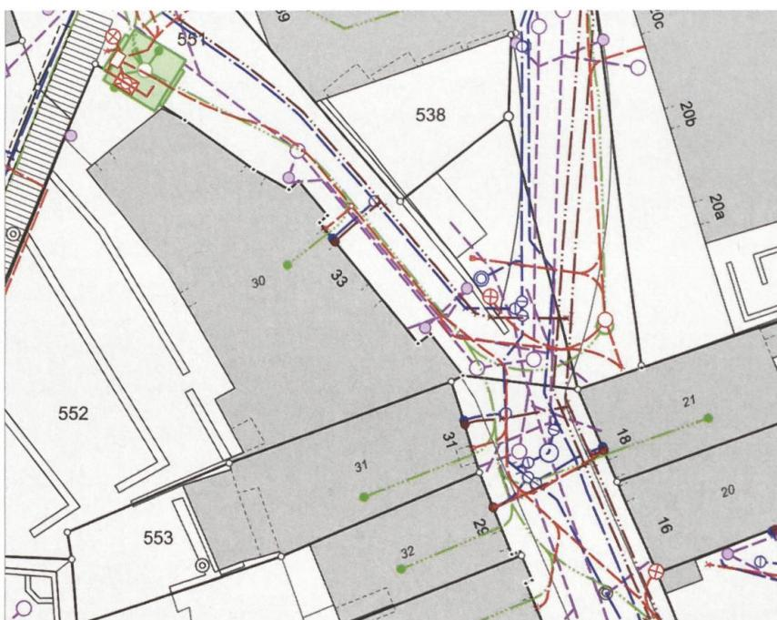
In der Kronengasse werden im Jahr 2000 die Werkleitungen erneuert. Rechts neben dem Abwasserrohr sind der Rohrblock für die Elektrokabel und daneben, überdeckt, die Wasser- und die Gasleitung sichtbar. Die Stromversorgung erfolgt über Provisorien entlang den Fassaden.
