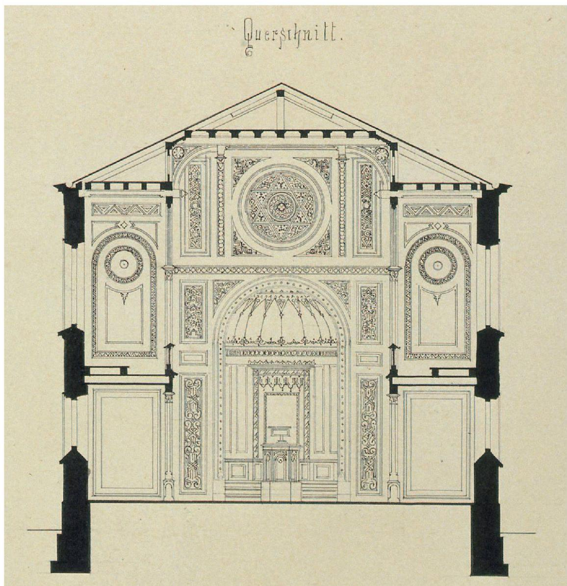
Querschnitt des Projekts von Moser. Das Synagogeninnere ist als dreischiffige Emporen- halle konzipiert: Mittelschiff und Seitenschiffe weichen in ihrer Höhe nur geringfügig
