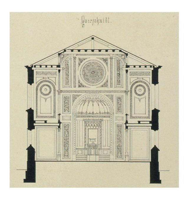
Querschnitt des Projekts von Moser. Das Synagogeninnere ist als dreischiffige Emporenhalle konzipiert: Mittelschiff und Seitenschiffe weichen in ihrer Höhe nur geringfügig voneinander ab. In der mit Wandmalereien reich verzierten östlichen Mittelschiffwand kennzeichnet eine Rundbogennische den Platz des Toraschreins.
