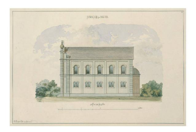
Seitenansicht des Projekts von Moser. In der zurückhaltend gestalteten, von Eckquadern gefassten Längsseite sind die einjochige Erschliessungspartie auf der Westseite und der anschliessende vierjochige Hauptraum identisch behandelt, was ein gleichmässiges fünfachsiges Fassadenschema ergibt.
