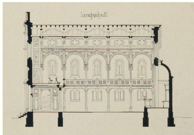
Längsschnitt des Projekts von Moser. Der Schnitt durch das fünfjochige Gebäude zeigt, dass für die Stützkonstruktion von Emporen und Dach wie schon in Lengnau und Endingen ein leichtes
