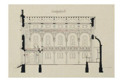
Längsschnitt des Projekts von Moser. Der Schnitt durch das fünfjochige Gebäude zeigt, dass für die Stützkonstruktion von Emporen und Dach wie schon in Lengnau und Endingen ein leichtes hölzernes Ständersystem vorgesehen war. Eine Kombination aus feinen, ausgesägten Holzverzierungen und dekorativen Wandmalereien hätte den Raum geschmückt.
