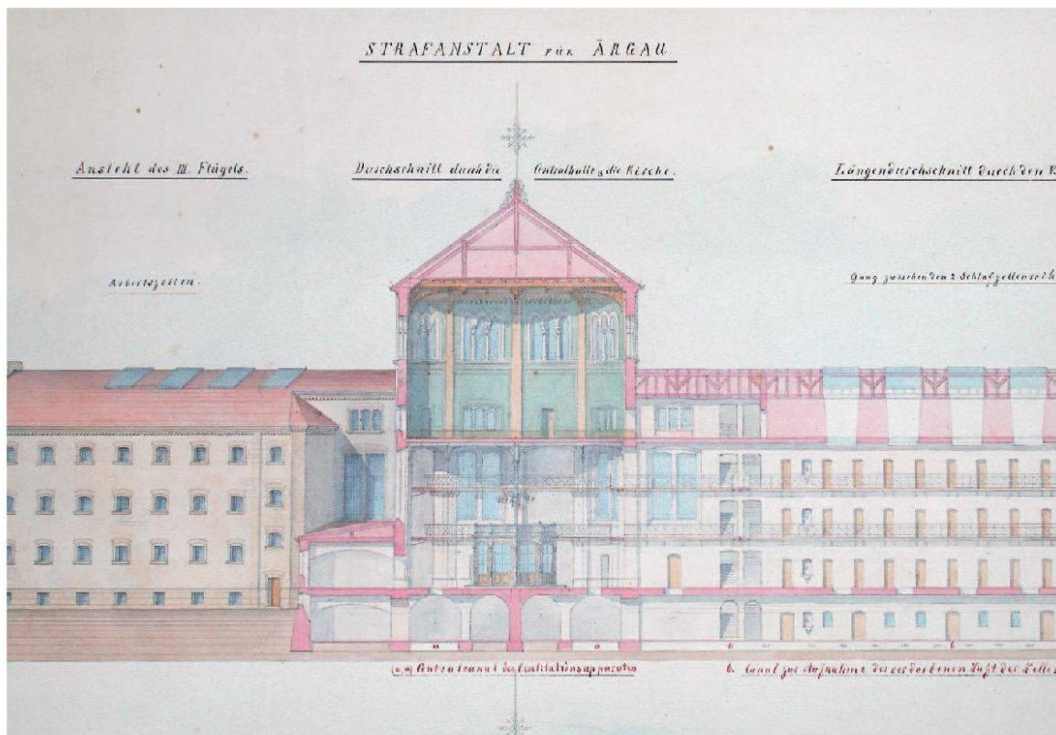
Robert Moser befasste sich vornehmlich mit neuen zeitgenössischen Bauaufgaben wie dem Gefängnisbau: Hier ein Querschnitt durch die Strafanstalt Lenzburg, die 1864–1866 nach Plänen Mosers erbaut wurde. Alle fünf Zellenflügel können von der «Centralhalle» aus überwacht werden, weshalb man von einer «panoptischen» Anlage spricht.
