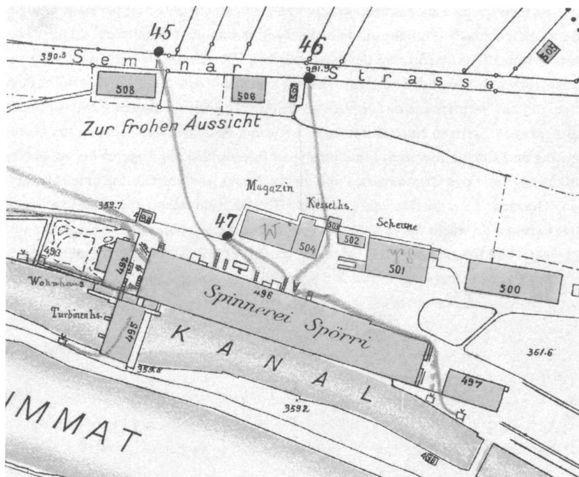
Grundriss des Spinnereiareals mit (teilweiser?) Einzeichnung des Feuerwehrdispositivs. Schlauchleitungen von den Hydranten Nrn. 45–47 und von weiteren Hydranten beim Landvogteischloss und bei der
