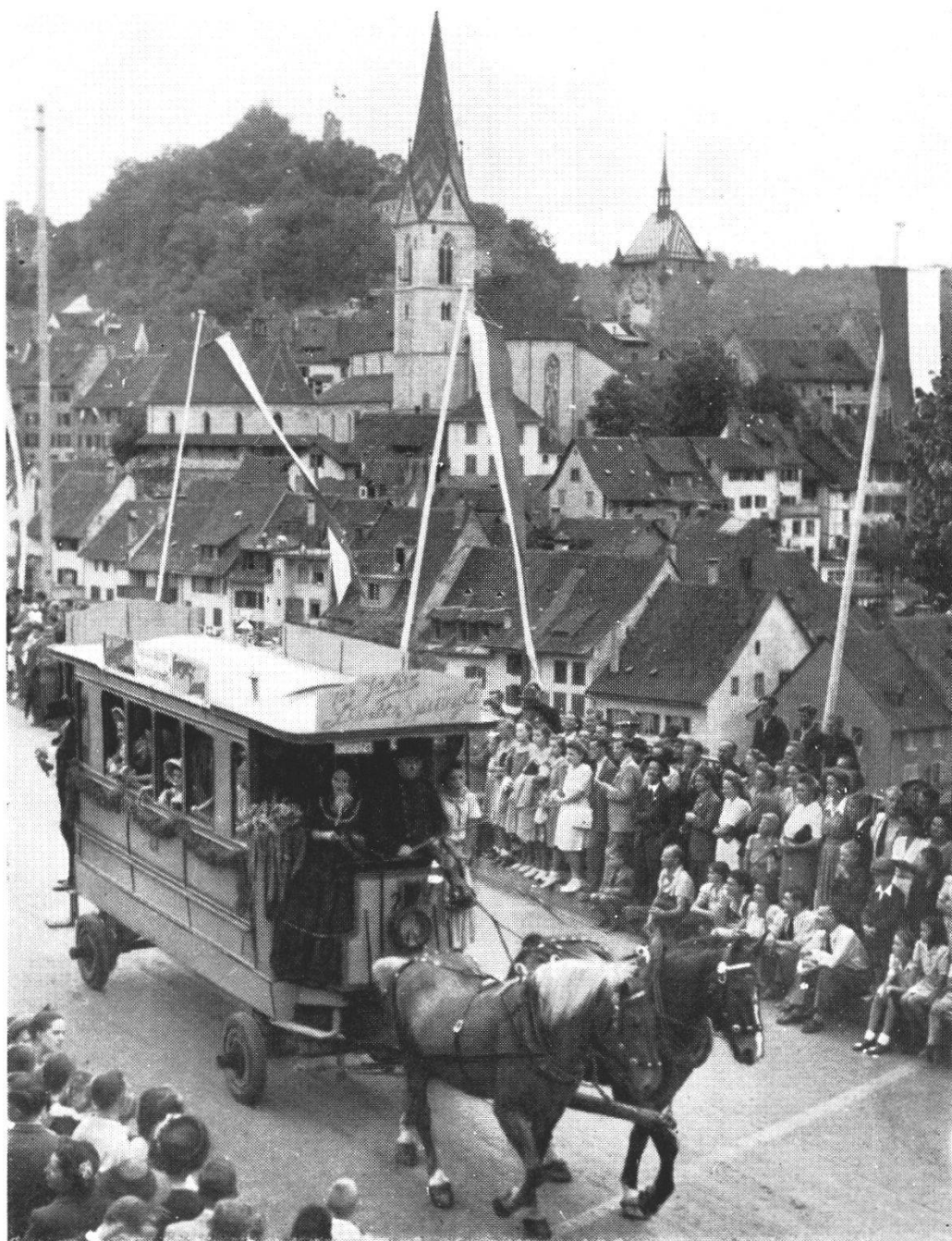
Rösslitram (Schweiz. Technikerverband, Sektion Baden) Rekonstruktion aus einem alten Tramwagen aus Vevey durch die Depotwerkstätte der Städtischen Strassenbahn Zürich. Photo: Photopress
