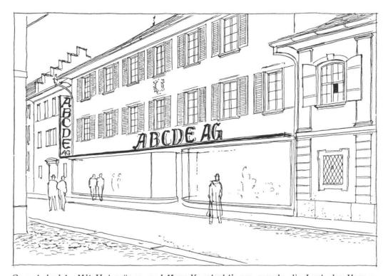
Gegenbeispiel. Mit Unterzügen und Krag-Konstruktionen wurde die Last des Hauses abgefangen. Die Stockwerke scheinen in der Luft zu schweben.
