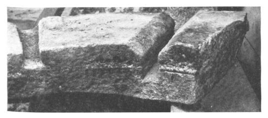
Abb. 10 Teil des alten Verteilerkranzes. Abb. 8, 9. 11, 12 Fhoto: Schaich (Bauamt Baden)
