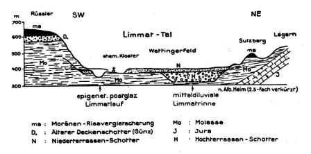
Abb. 2 Querprofil durch das untere Limmattal.
