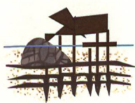
Lors des reprises par le lac, le sable ne se dépose pas jusqu'au sommet des tas qui interrompent la sédimentation normale.
