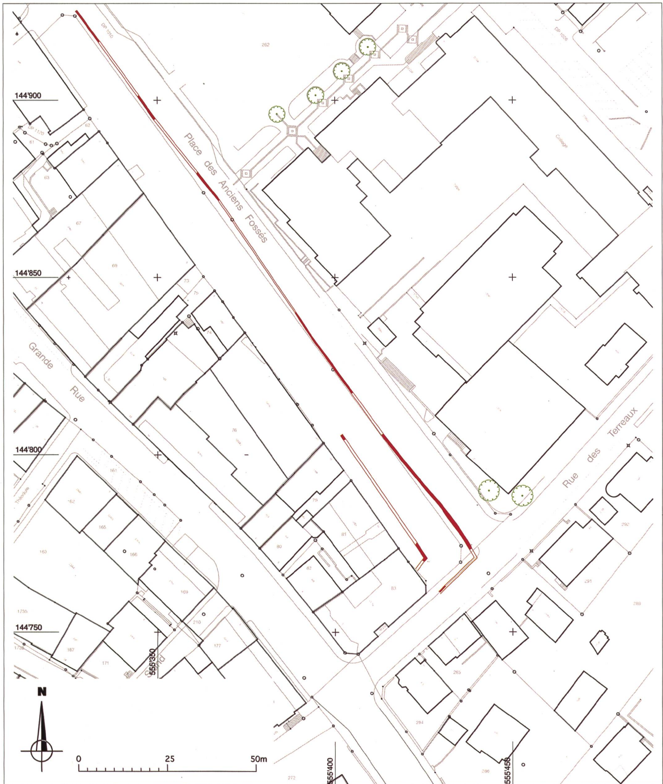
Fig. 8 LA TOUR-DE-PEILZ – Place des Anciens Fossés. Plan schématique des fortifications médiévales, avec le mur de braie à gauche et le mur de contrescarpe à droite (DAO Archeodunum SA, Y. Buzzi, A. Moser).
