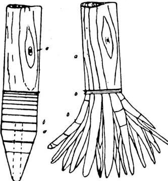
entourée de cercles en fer dont l'écartement augmente en se rapprochant de l'extrémité. La pointe est percée d'un trou dans lequel on place l'explosif; ce trou est ensuite refermé par un bouchon.
