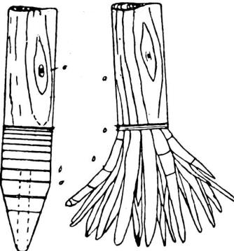
entourée de cercles en fer dont l'écartement augmente en se rapprochant de l'extrémité. La pointe est percée d'un trou dans lequel on place l'explosif; ce trou est ensuite refermé par un bouchon.
