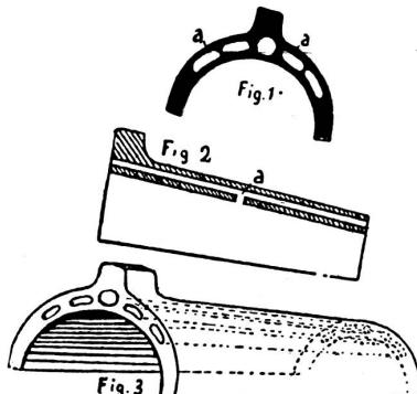
de fenêtres a le désavantage de laisser pénétrer la pluie, la neige et les animaux (pigeons, chauves-souris, etc.). Les figures 1, 2 et 3 représentent une tuile faîtière qui sans avoir les inconvénients d'une fenêtre assure la ventilation de la toiture par des canaux qui sillonnent ses parois dans le sens longitudinal.
