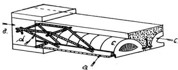
truction de planchers qui est destinée à se répandre rapidement. L'armature est composée de fers a, d et e.
