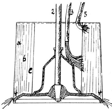
et a de plus sur le revêtement du four une fâcheuse influence. Par l'appareil centrifuge ci-dessus on peut réduire à 20 ou 25% la quantité d'eau. Le reste peut alors être facilement vaporisé dans les fours. Le tuyau 3 amène la pâte semi-liquide qui se divise alors en pâte plus épaisse et en eau. La première sort en 4 et est recueillie dans un récipient pour être envoyée au four. Le tuyau 5 emmène l'eau hors de l'appareil.
