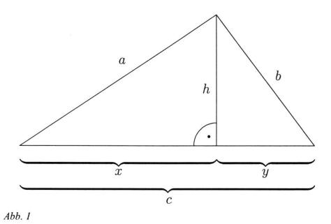
Die Höhe h teilt die Grundseite in 2 Teilstrecken x und y, so dass sich 2 rechtwinklige Dreiecke (mit den Seiten a, x und h bzw. h, y und b) ergeben. Auf diese beiden Dreiecke wendet man den Satz des Pythagoras an (wobei die ursprünglich zur Bezeichnung der Dreieckseiten verwendeten Kleinbuchstaben nun für die Zahlenwerte ihrer Längen stehen sollen):
