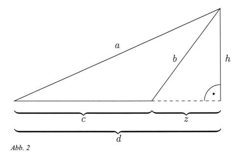
Die Längen der Seiten a, b und c seien wieder als bekannt vorausgesetzt. z ist die Verlängerung von c bis zum Fusspunkt von h. Kennt man die Länge von z, kann man die von h mit dem Satz des Pythagoras bestimmen. Die in Fall A ermittelten Formeln für x und y nützen einem hier scheinbar nichts. Bei näherer Betrachtung (s. Tab. 1) entdeckt man aber in Fall B Strecken, deren jeweilige geometrische Funktion sich mit der von x bzw. y deckt.
