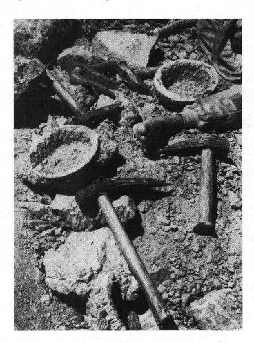
Abb. 15: Zwischen den Füssen des Handwerkers liegt eine ausgehauene Schale. Mit verschiedenen Werkzeugen wird das Gefäss fertig bearbeitet. Specksteinbruch am Djebel Al-Mishima bei Monabeh, 1995.
