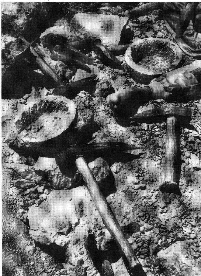
Abb. 15: Zwischen den Füßen des Handwerkers liegt eine ausgehauene Schale. Mit verschiedenen Werkzeugen wird das Gefäß fertig bearbeitet. Specksteinbruch am Djebel Al-Mishima bei Monabeh, 1995.
