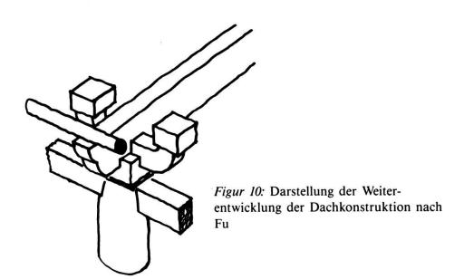
«Die *liang*-Balken kreuzen sich mit über den Pfeilern verlaufenden Querarmen, das *liang*-Ende ragt hervor und bildet den um eine Stufe hervorspringenden Konsolarm, (der) *huagong* (genannt wird). Der Traufbalken ruht auf diesen *huagong*» (vgl. Fig. 10). Bei dieser Lösung bestimmen die Enden der *liang*-Balken (bzw. *huagong*, nach Fu), d.h. ihr Abstand zur Wand, das Maß, um das der Traufbalken über die Wandfläche der Traufseite hinausragt<sup>25</sup>.
