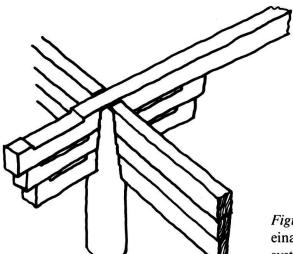
Figur 9: Darstellung eines übereinander gesetzten Konsolsystems, Lösung b)
