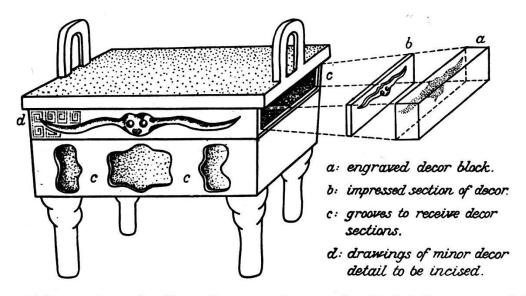
Fig. 9. Rekonstruktion der Herstellung eines keramischen Models für Bronzeguß der Shang-Zeit, mit eingesetzten Dekorpartien. (Barnard, a.a.O., Fig. 24.)
