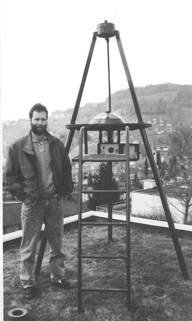
Abb. 2: Mit einer Leiter gelangt der Operateur jeweils hinauf zum Kameragehäuse an der Dreibeinspitze. Die Spiegelsäuberung und das Entfernen von Spinnweben gehören ebenfalls zu seinen Aufgaben.
