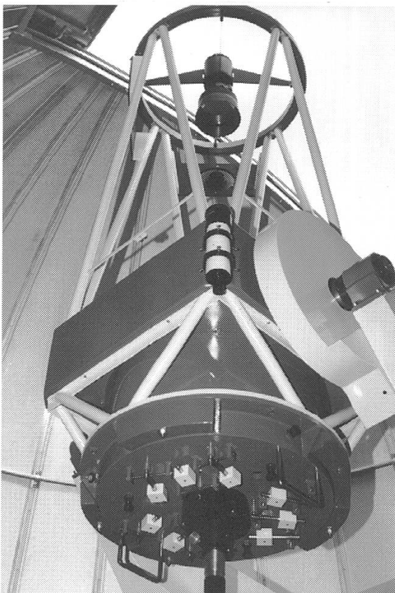
Abb. 2: In der Kuppel: Das imposante 60-cm-Newton-Cassegrain-Teleskop.
