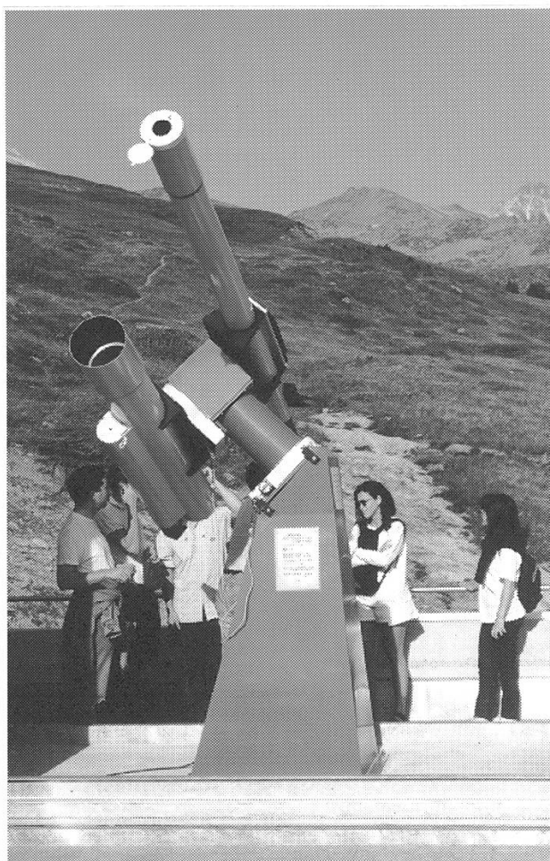
Abb. 3: Auf der Sonnenterrasse: Der 15-cm-Koronograph (rechts) und der gemeinsam montierte Schär-Refraktor.
