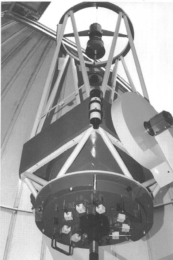
Abb. 2: In der Kuppel: Das imposante 60-cm-Newton-Cassegrain-Teleskop.
