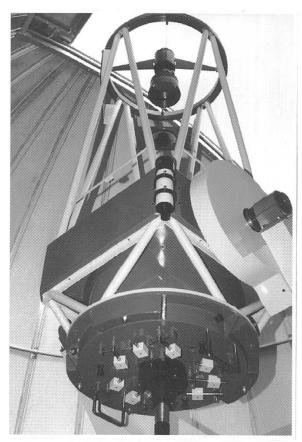
Abb. 2: In der Kuppel: Das imposante 60-cm-Newton-Cassegrain-Teleskop.
