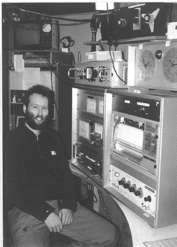
Abb. 5: Der Autor an der Datenempfangsanlage und Kurvenschreiber.
