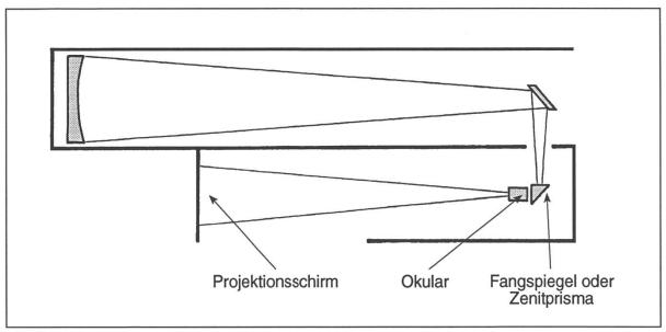
Abb. 1: Projektion des Sonnenbildes an einem Newton-Teleskop.
