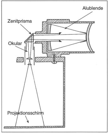
Abb. 3: Die Projektionseinrichtung für das C90.
