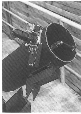
Abb. 2: Fangspiegelbefestigung, Okularauszug mit Handsteuerbox und Telrad-Sucher.
