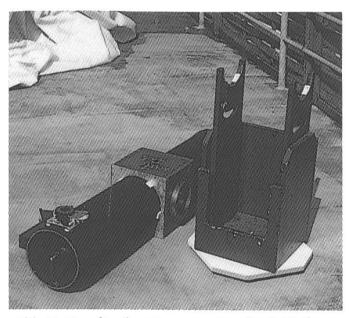
Abb. 5: Das für den Transport zerlegte Dobson.
