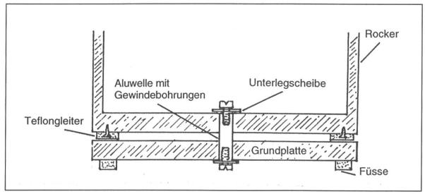
Abb. 3: Das einfache Prinzip der Azimut-Achse.
