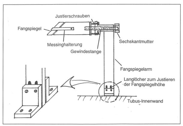
Abb. 1: Die Konstruktion des Fangspiegels.
