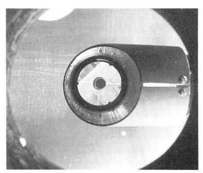
Abb. 5: Blick in den Okularauszug eines Newton-Teleskops. Der Hauptspiegel liegt links.
