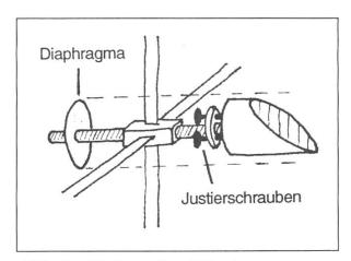
Abb. 2: Einbau des Diaphragmas vor den Sekundärspiegel.
