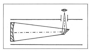
Abb. 1: Spiegelteleskop nach Newton.
