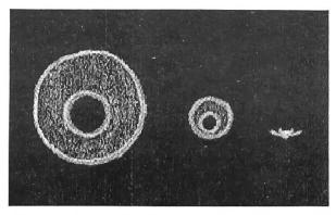
Abb. 6: Scharfstellverlauf am 25 cm f/5 Netwon-Teleskop mit exzentrische eingebauten Fangspiegel.
