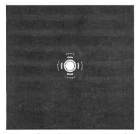
Abb. 8: Das durch Fangspiegelarme zerstückelte Beugungsbild.
