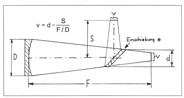
Abb. 4: Newton-Teleskop mit vignettierungsfreien Bildfeld.
