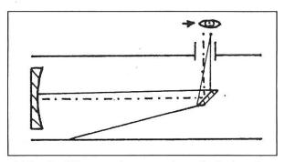
Abb. 2: Vignettierung durch Seitenbewegung des Auges.
