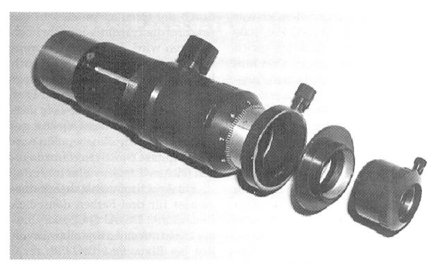
Abb. 2: Von links nach rechts der Fokussiertubus mit ½0 mm Skalenteilung, ein Wechselring (Ringschwalbe) und eine 1.25" Okularklemmhülse.
