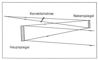
Abb. 2: Prinzip eines Schiefspieglers.
