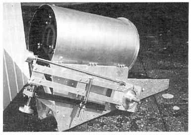
Abb. 3: Das Hauptspiegelaggregat mit Deklinationsfeintrieb.
