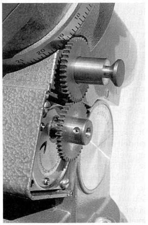
Abb. 5: Der Rektaszensionsmotor mit abgenommener Schutzhaube und Klemmring.
