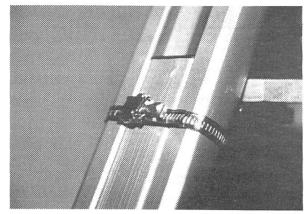
Abb. 6: Der mit einer Schlauchbride verstärkte Stativschenkel.
