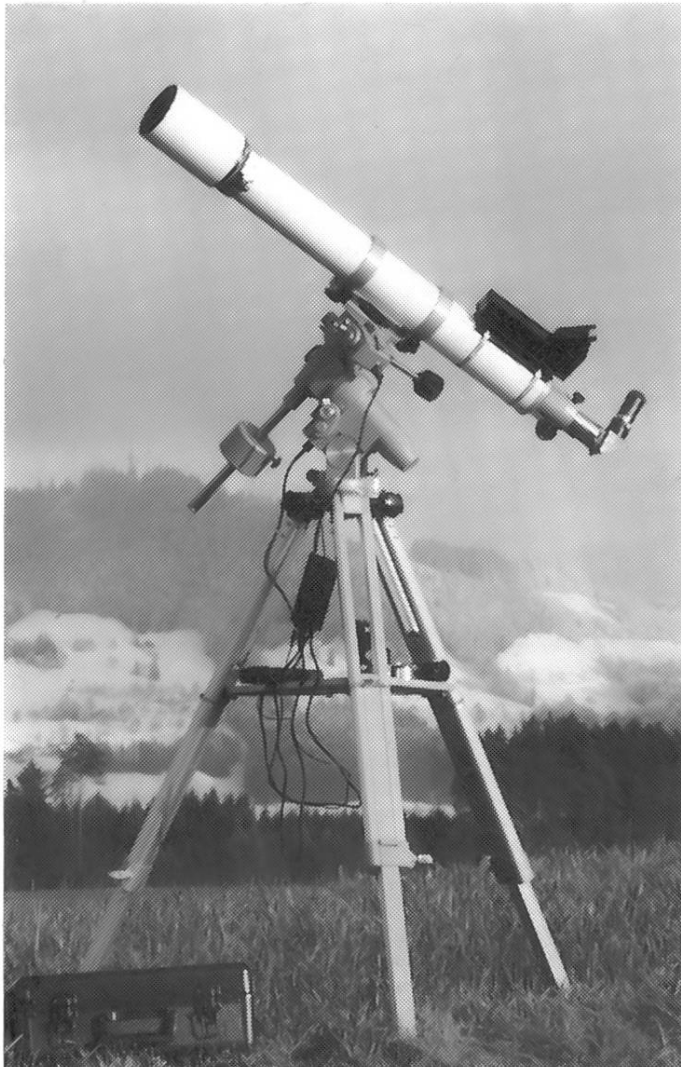
Abb. 1: Das Vixen 90M mit Super Polaris-Montierung und modifiziertem Alu-Stativ.
