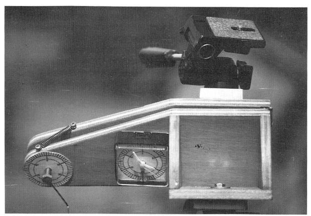
Abb. 4: Die Zifferblätter sind auf Folie gezeichnet und auf einen mit Nachtleuchtfarbe bestrichenen Karton geklebt. Die Uhr wurde nur mit doppelseitigem Klebeband fixiert und kann für den Batteriewechsel abgenommen werden. In die Schraube habe ich ein kleines Loch gebohrt und darin einen kleinen Inbus-Schlüssel gesteckt.
