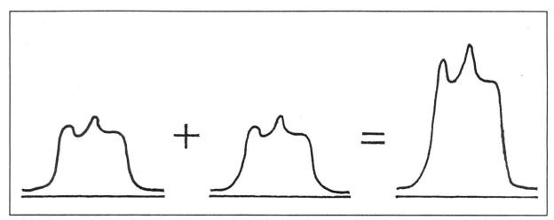
Abb. 2: Die beim Sandwichen sich addierenden Dichtekurven zweier gleich lang belichteter Negative.
