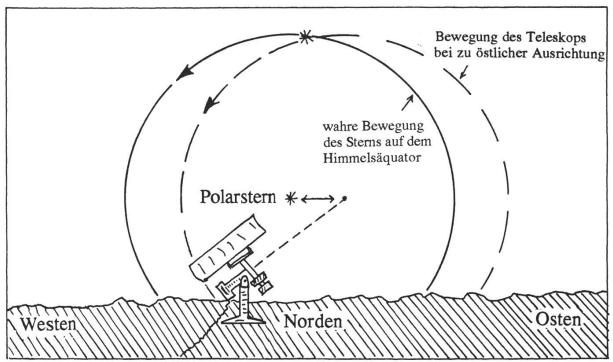
Abb. 1: Ost-West-Abweichung der Polachse.
