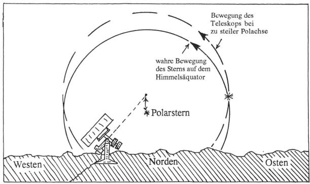
Abb. 2: Nord-Süd-Abweichung der Polachse.
