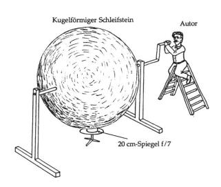
Nein, nein, so eben nicht! Man fixiert die Schleifschale auf einem stabilen, runden Tisch, streicht mit dem Pinsel etwas nasses Schleifpulver (grobes Karborundum-Korn) drauf, legt den zukünftigen Spiegel auf und bewegt diesen vor- und zurück während man um den Schleifbock herumgeht.
