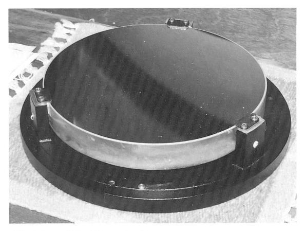
Abb. 4: Der geklebte Hauptspiegel
