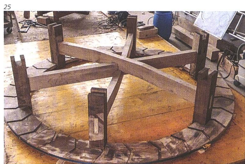
Abb. 25 Zusammenbau des grossen Wasserrades in der Werkstatt.
