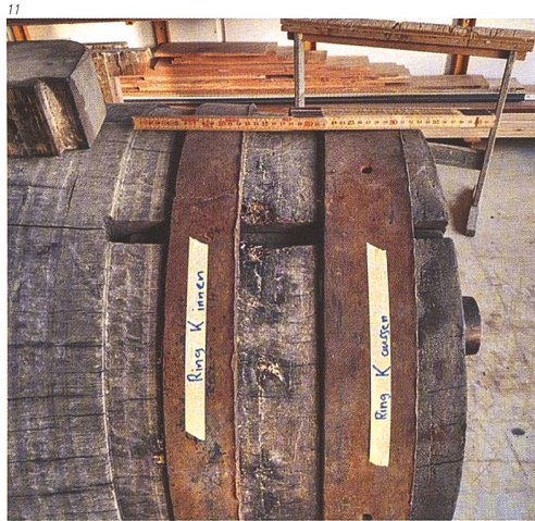
Abb. 13 Der demontierte Hammerbock im Vorzustand.
