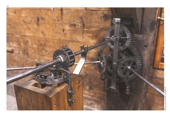
Abb. 16 Im Vordergrund die Umlenkung vom Zeigerwerkantrieb nach unten zum astronomischen Zifferblatt. Im Hintergrund das Zeigerwerk für das Zifferblatt Nord, mit Umlenkungen nach West und Ost. Zustand nach der Restaurierung 2022.
