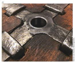
nicht mehr verwendet werden konnte (Abb. 23). Wo immer möglich wurde aber versucht, Verschleissspuren durch Aufschweissen und Nachbearbeiten zu beseitigen, um die Teile weiter verwenden zu können. Eine Neuanfertigung ist immer die letzte Option.
