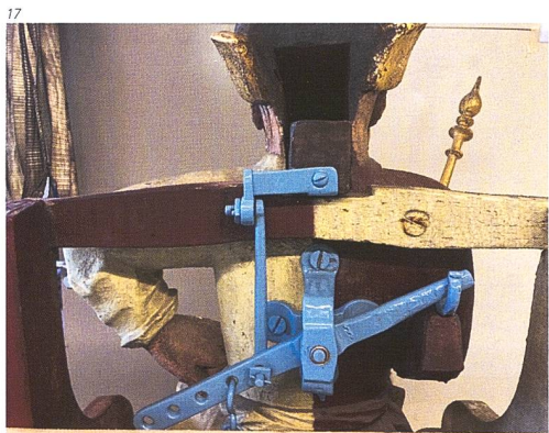
Abb. 17 Detail des Mechanismus beim Narrenkönig, der die Bewe- gung des linken Armes und des Unterkiefers ermöglicht. Zustand nach der Restau- rierung 2022.
