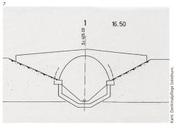
UHFB-Platte dient als lastverteilendes Bauteil und als abdichtende Schutzschicht über der Mauerwerkskonstruktion zur Unterbindung eines Wassereintrags in die Brückenkonstruktion.
