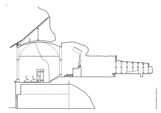
Abb. 7 Längsschnitt durch die Verenakapelle mit angebauter Vorhalle und nach hinten natürliche und künstliche Höhle mit dem Kreuzaltar und dem Heiliggrab. Planaufnahme 1:100, wwb Architekten, Februar 2019.
