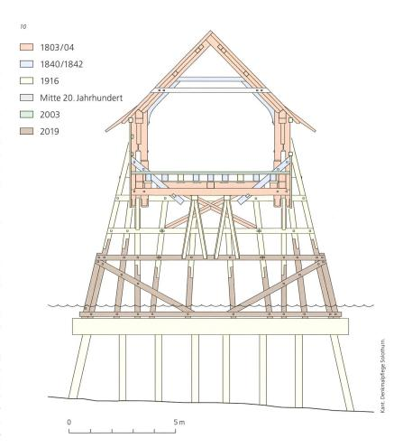
einem dreifach geführten Sprengwerk, das gespreizte Streben sowie verkeilte und verzahnte Spannriegel besitzt. Die drei doppelten Hängepfosten umklammern zangenartig die gespreizten Streben und zwei übereinanderliegende, miteinander verzahnte Brückenlängsträger, auch Streckbalken genannt. Letztere liegen auf doppelt geführten Brückenquerträgern auf, die mit den Hängepfosten verschraubt und unterhalb der Fahrbahn von einem durch An-
