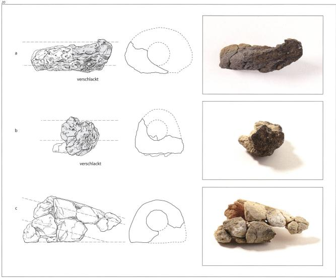
um Schicht, mit Holzkohle und Eisenerz gefüllt. Nach einer gewissen Zeit kommt es zur chemischen Reaktion, bei der das Eisenerz zu Schlacke und Eisen umgewandelt wird. Die Begleitmineralien des Eisenerzes, wie Quarz und Ton, schmelzen und bilden dabei die Schlacke. Während die Schlacken abtropfen und aus der Ofentür in die Bedienungsgrube rinnen, sammeln sich die feinen Eisenpartikel im Ofen zu einem zähflüssigen Eisenschwamm. Dies geschieht in der Nähe der Düse über der Ofensohle.
