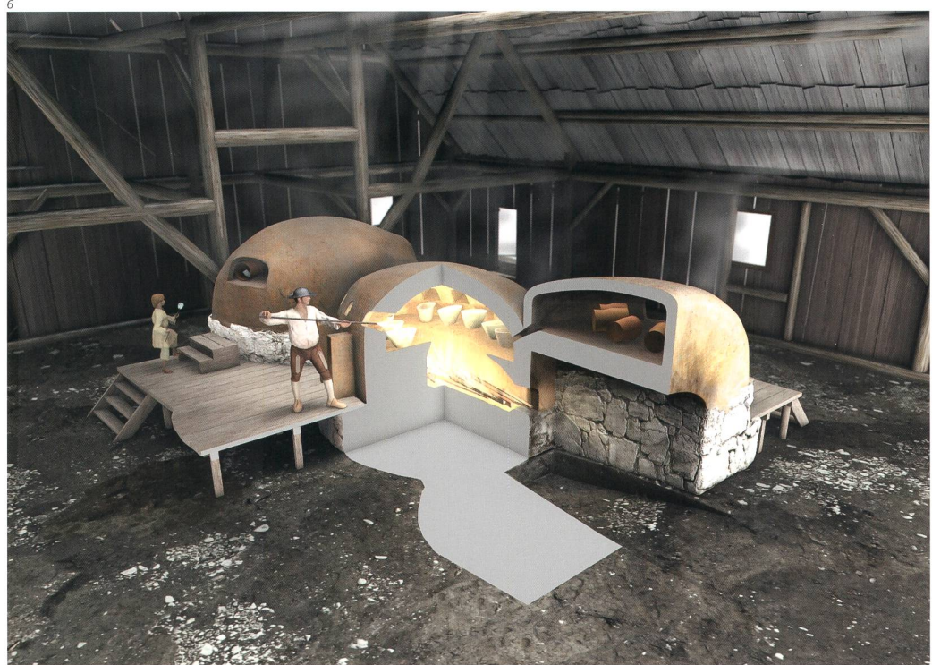
Abb. 6 Rekonstruktion des grossen Ofens in der frühneuzeitlichen Glashütte von Court im Kanton Bern (aus: Gerber u. a. 2012, Abb. 198).
