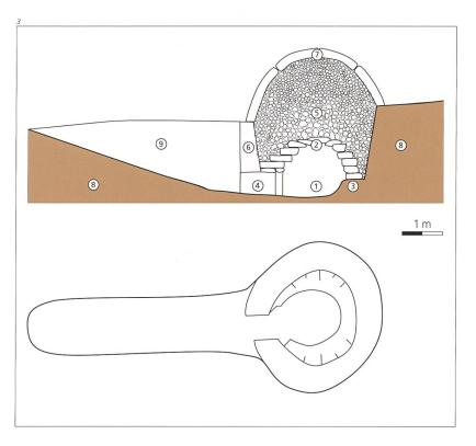
als Erstes ein luftdurchlässiges Gewölbe errichtet, der sogenannte Himmel. Dieses Gewölbe ruht auf einem umlaufenden Vorsprung in der Feuerkammer, der sogenannten Ofenbank. Die Ofenbank und der Himmel trennen die Feuerkammer von der Brennkammer. Diese wird mit einer Ladung von Kalksteinen, der sogenannten Charge, befüllt oder beschickt, wie der Kalkbrenner sagen würde.
