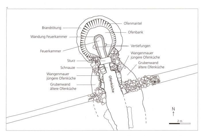
Abb. 6 Ofen 1 mit seinen verschiedenen Konstruktionselementen. M 1:100.
