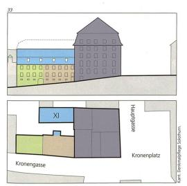
korridor erschloss die gassenseitigen Zimmer, zudem entstand durch das Verlegen des alten Portals gegen Norden ein direkter Zugang in ein neues Treppenhaus. Hofseitig wurde ein Toilettenturm angehängt. Ein neuer, im Hof an das Hauptgebäude angebauter zweigeschossiger Wirtschaftsflügel vervollständigte die Erneuerungsarbeiten. Für diese Arbeiten erhielt der Wirt von der Obrigkeit Bauholz im Umfang von «32 Stück Träm, 24 Stück Riegel und 42 Stück Rafen» <sup>26</sup> zugesprochen.
