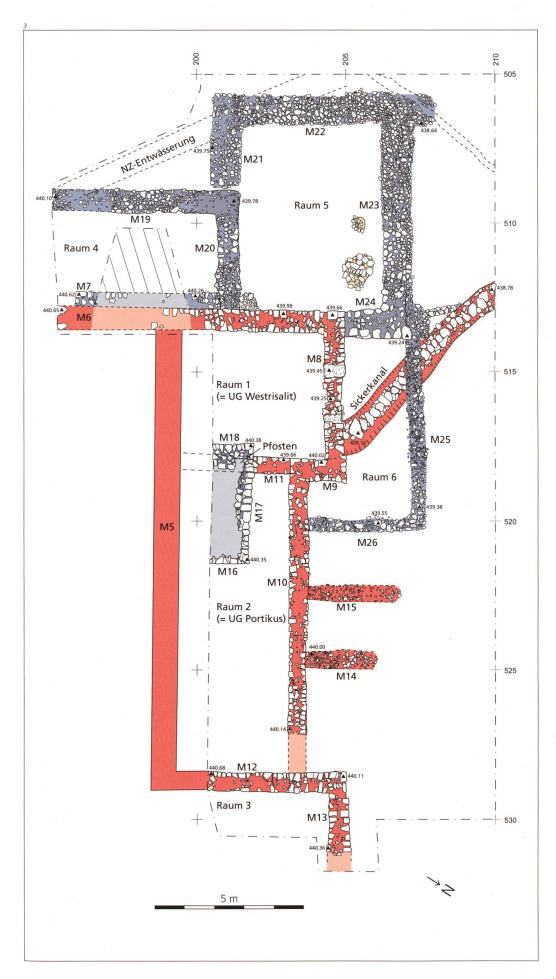
Abb. 3 Ausgrabung 2013. Steingerechter Befundplan der Villa. Rot Phase 1: Grundbau 2. Jh., Blau Phase 2: Anbauten 3. Jh. M1:125.
