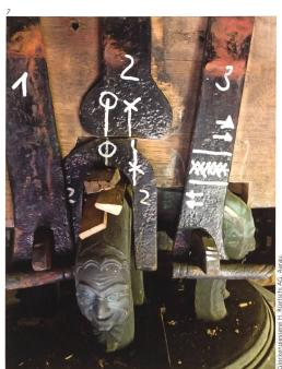
Abb. 5 Die Rosenkranzglocke (Nr. 6) von 1767, Detail des Schlagringes mit Abguss eines Rosenkranzes. Gut sichtbar die Drehung der Glocke: Links des neuen Klöppels die stark ausgeschlagene Stelle an der Kante, verursacht durch den ersten Klöppel, darin eine heller glitzernde Stelle vom neuen Klöppel von 2008; unmittelbar rechts des Klöppels Abdruck der neuen Anschlagsstelle in heutiger gedrehter Position. Foto 2015.
