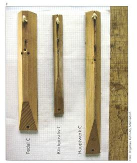
Rahmen besitzen eine Schiebekoppeleinrichtung. Nach den Spuren zu urteilen, wurde von Metzler versucht, diese Koppel in Funktion zu setzen. Deren Konstruktion ist allerdings so unzulänglich, dass dies nicht funktionieren konnte.
