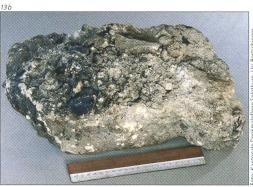
Abb. 13 Fundstück des Gussmörtelbodens über der obersten Geschossdecke des alten Turmes von 1408. Glatt abgeriebene verdichtete Oberfläche (Bild links), darunter zum Teil grobes Korn (Bild rechts), viele Kalkeinschlüsse. Beispiel eines trocken gelöschten Kalkmörtels, typisch für mittelalterliche Mörtel.
