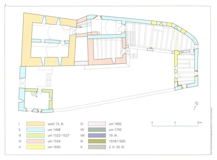
Abb. 8 Erdgeschoss, Grundriss 1:250. Hauptbauphasen gemäss Befundauswertung der Bauuntersuchung von 2009/2010.
