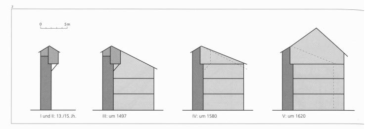
Abb. 3 Schematische Darstellung zur Entwicklung der Baukubatur an der Schmiedengasse 23.
