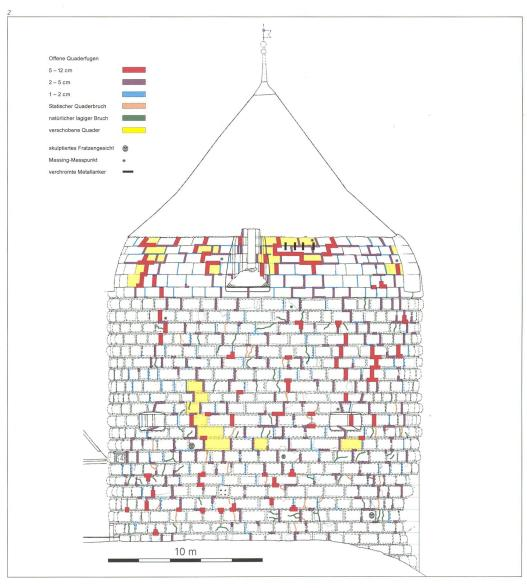
Abb. 2 Photogrammetrischer Aufnahmeplan der Ostseite. Schadenskartierung des Quadermauerwerks.
